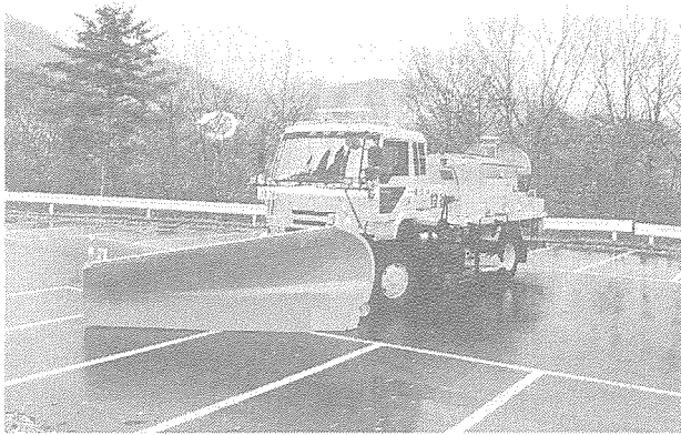
写真一 除雪トラック (10t級, 355ps プラウ, 凍結抑制剤散布装置搭載)
