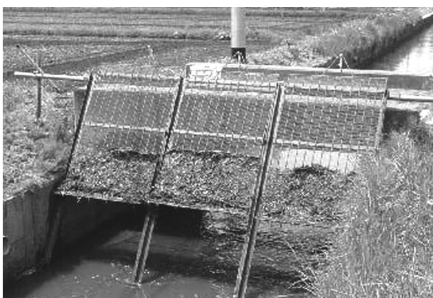
平成15年には、地域におけるわらの排出状況を調査 図1 稲わら流出調査のための集塵装置
