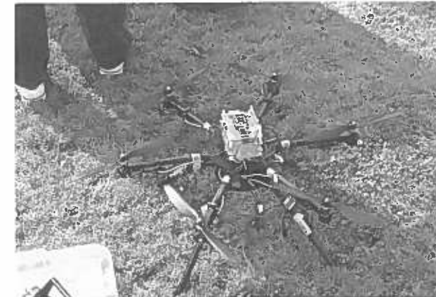
写真3. 電動マルチロータークラフト外観
