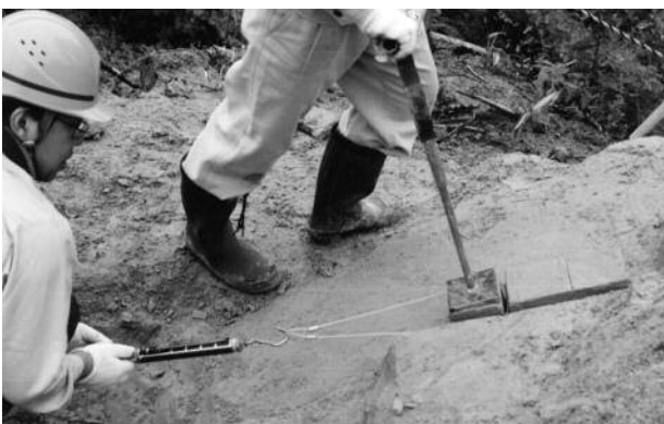
写真 7. 原位置一面せん断試験
