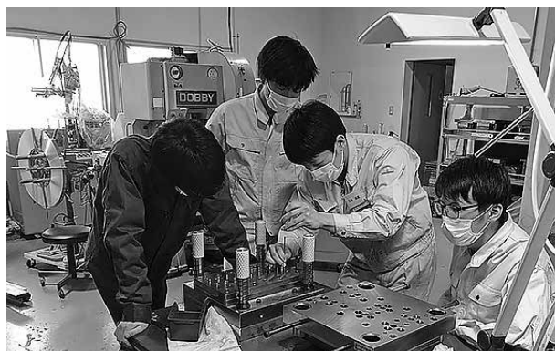
写真7. プレスチームの金型組立調整作業
