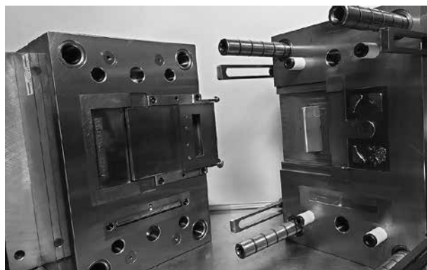
写真8. 組み立てた樹脂成型金型
