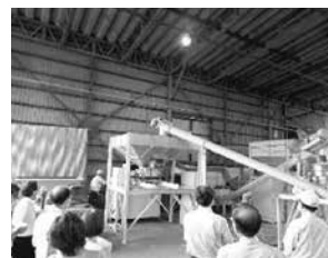
写真12. ガラス粉砕片回収装置 (ガラス分離ライン)
