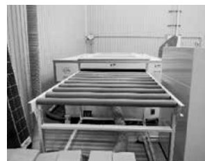
写真10. モジュール分離装置 (PVスクラッチャー)
