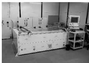
写真7. 太陽光パネル モジュール診断システム
